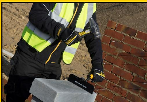
Einfache Handhabung des Gorilla Block Buster. Messen Sie einfach Ihren gewünschten Schnitt und positionieren Sie die Klinge auf dem Stein.
